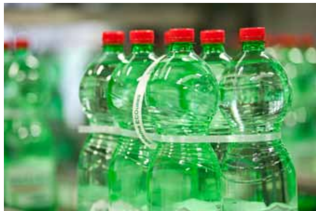
LitePac: alças de PET e PP substituem filme termoencolhível.
