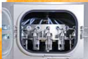
Contipure: esterilização gasosa da pré-forma.
