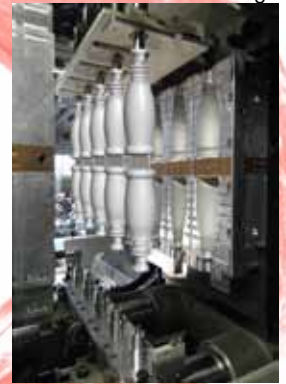
Tandem: sopro por cima e por baixo de garrafas de leite.
