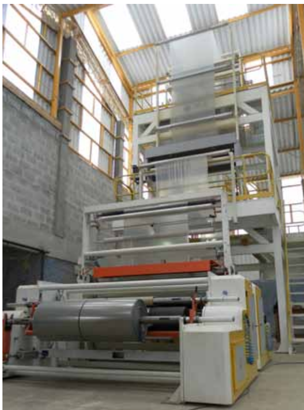
Nitrus VR 65 mm: produção de até 200kg/h com duplo anel de ar.
