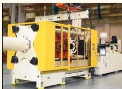
Hyletric: Husky aposta na injeção híbrida com modelo Hyletric.
