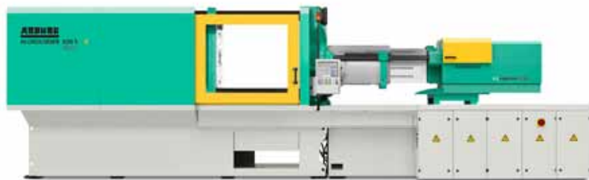
Arburg Allrounder 820 S: compostos com fibra de vidro de até 100 mm de extensão.
