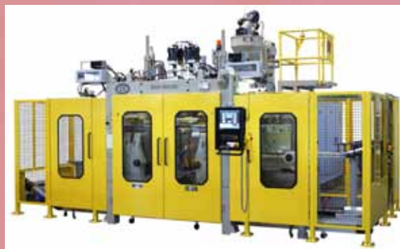
BM 606 D: ciclo a seco de 3,4 segundos.
