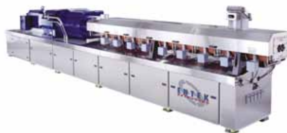
Entek: dupla rosca de 103 mm de diâmetro para biomateriais.
