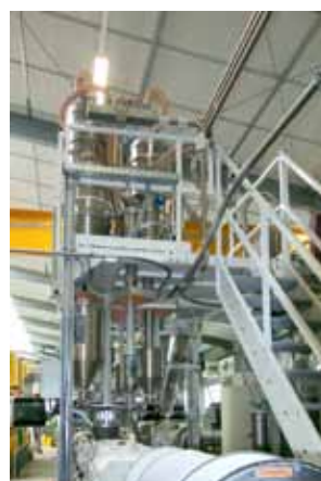
Piovan FDM: dosagem e transporte apuram transformação de PVC.
