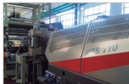
Linha MRS para fabricação de chapas PET para embalagens termoformadas para alimentos (Argentina)
