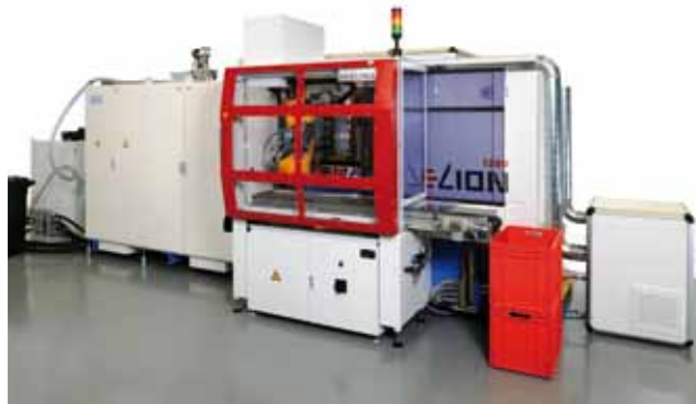
HekuCell: célula para injeção experimental em ciclo baixo.
