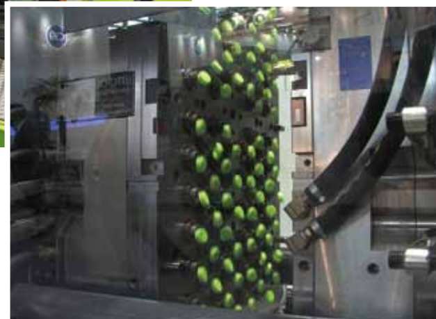
Injetora e-cap: tampas em ciclo inferior a três segundos.
