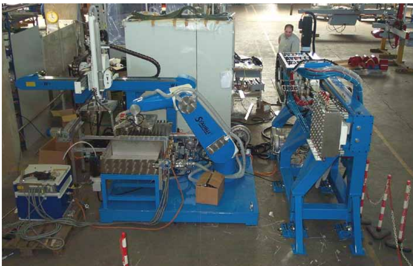
Robô Ginko PL: retirada de peças em baixas tiragens.
