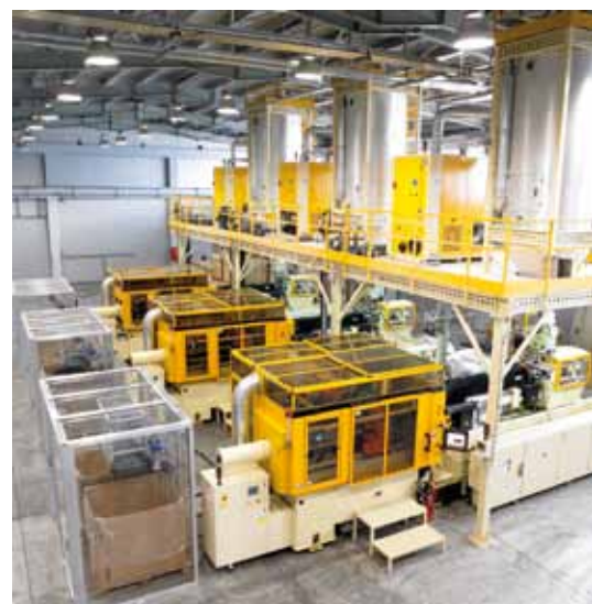
Célula Husky: pacote sem similar de injetora de pré-formas e periféricos.
