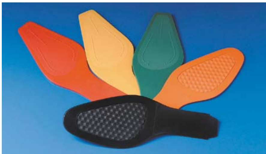
Solados de Fortipur 4222 Bio: degradação sob ação de intempéries.
