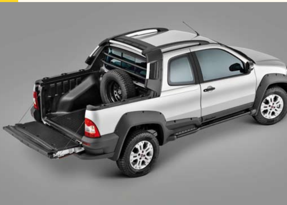
Strada: PP tira metal de componentes da caçamba.
