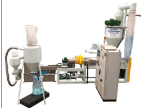
Challenger Recycler Conical: recuperação de aparas ao pé da máquina básica.
