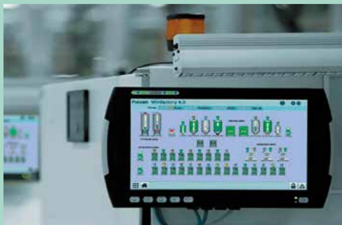
WinFactory 4.0: controle energético de cada máquina na linha de produção.
