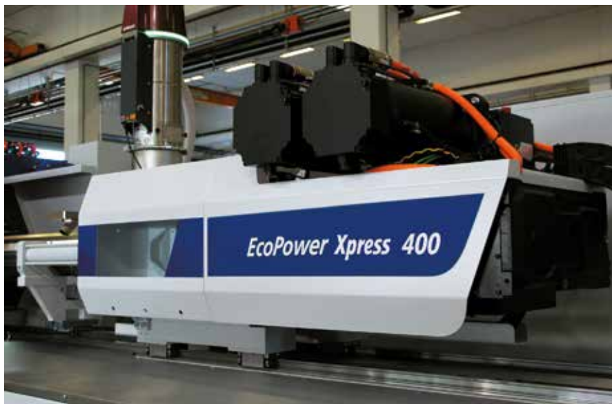
EcoPower Xpress: injeção acionada por dois servomotores.
