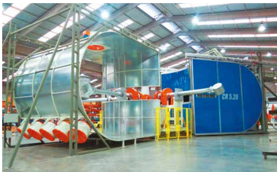
Rotoline CR 5.20: excelência do queimador e circulador de ar dentro do forno economiza gás na rotomoldagem.
