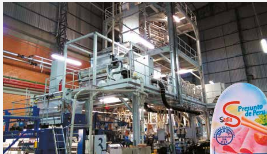
Reifenhäuser de 11 Camadas: filmes técnicos como o do presunto de peru Sadia.
