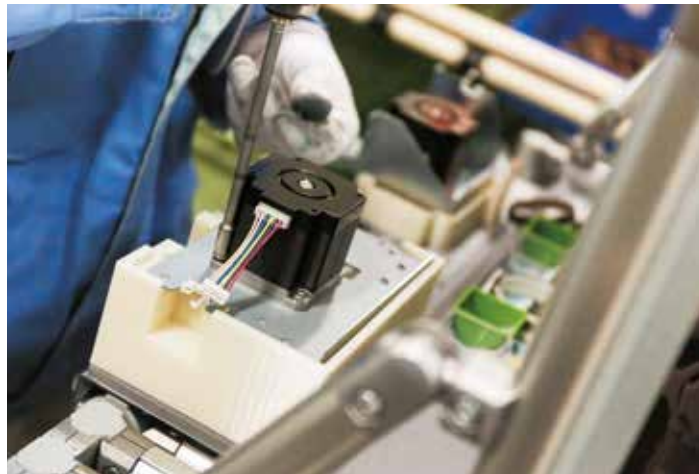
Montagem de componente eletroeletrônico com dispositivo de ABS antiestático impresso em 3D.
