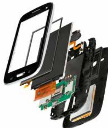
**Celulares: leveza, resistência a impacto e processamento abrem espaço para peças de Rilsan XZM 50.**
