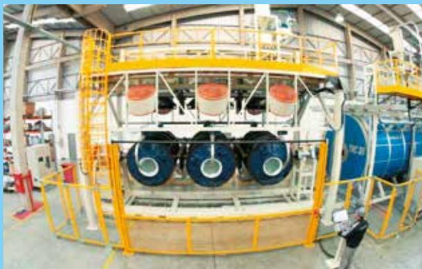
**TNC 30: rotomoldagem com forno fechado de tanques multicamada.**
