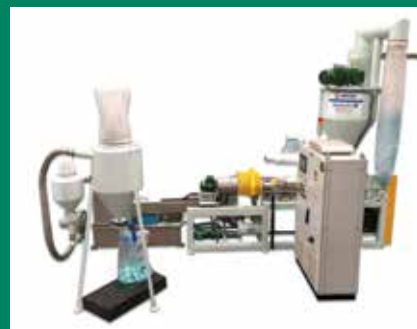
Challenger Recycler Conical 55mm Geração II : recuperação de aparas ao lado da extrusora.
