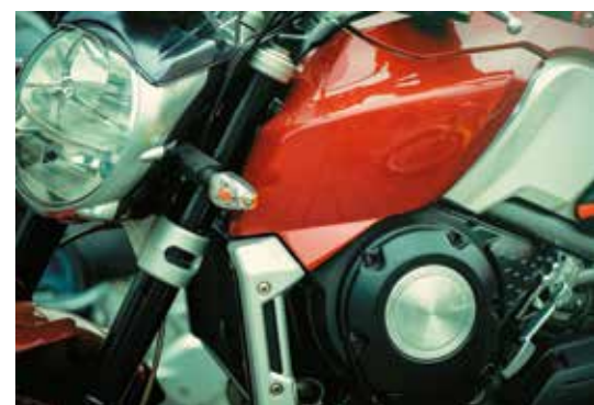
Tanque de moto: ofensiva de PA 6 sobre metal.
