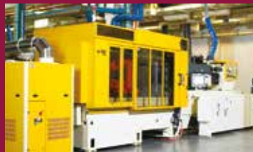
HYPET 400 HPP5: adequação a moldes de até 128 cavidades para pré-formas de garrafas de refrigerantes.
