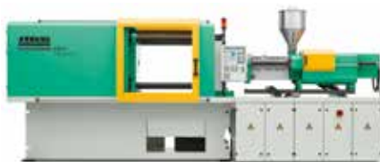
Allrounder 570 S: injetora hidráulica de 200 toneladas para ciclos altos.
