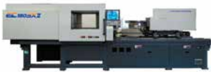
EC SX: molde protegido por sistema que checka o torque do servomotor.
