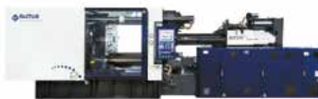
Júpiter: operação com sistema de duas placas.
