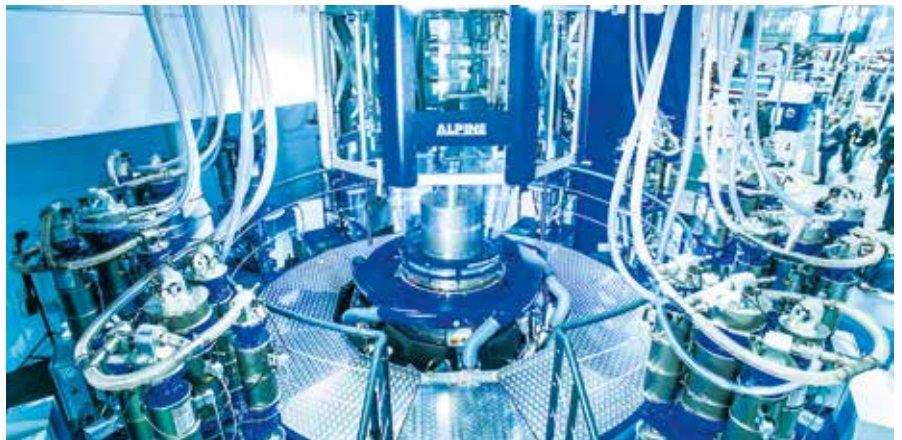
Coextrusora de 11 camadas: filme exige novos conhecimentos dos recicladores.
