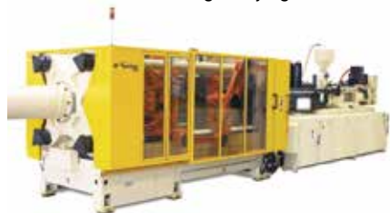
Husky Hylectric: máquina híbrida para ciclo rápido e parede fina.
