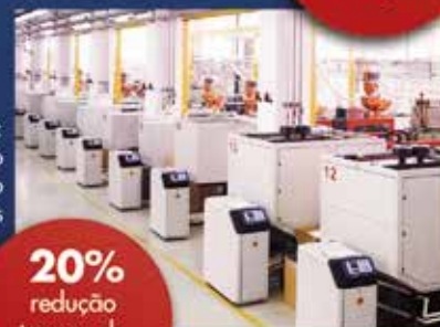
Microgel: resfriamento individualizado de moldes
