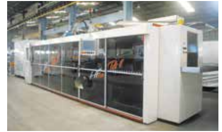
Hece HF-750 Tilt II: contagem, empilhamento e descarga organizada de potes e copos.
