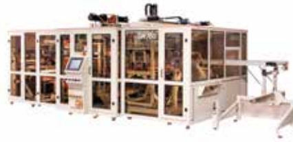
GN: corte e moldagem na mesma estação.
