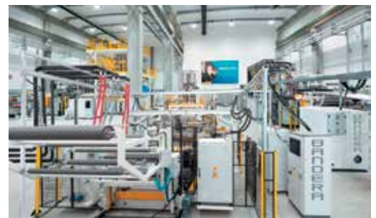
Extrusora de chapas de PET: dupla rosca corrotante com 3 zonas de degasagem.
