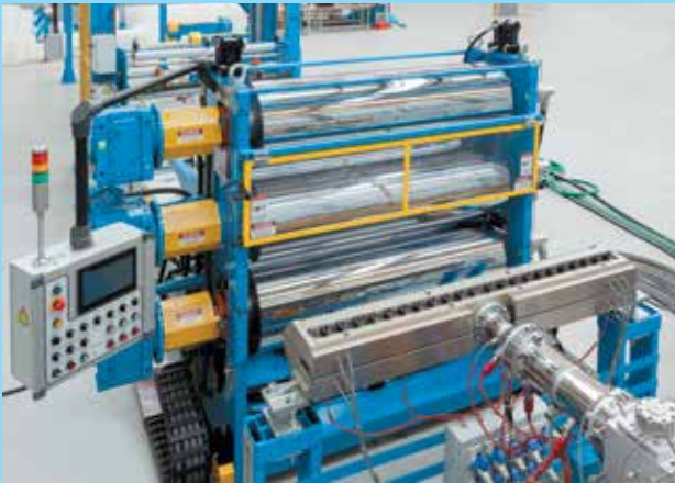
Amut Wortex: 900 kg/h de chapas coextrusadas de PP.
