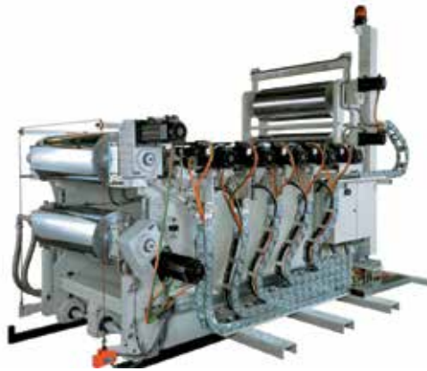
Calandra Multi-Touch: refrigeração uniforme dos dois lados da chapa.
