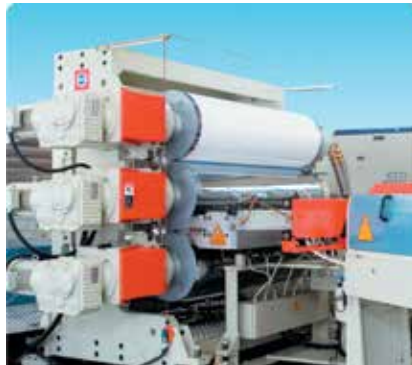
Extrusora Rulli Standard: versões de 300 a 2.000 kg/h de chapas para termoformagem de copos descartáveis
