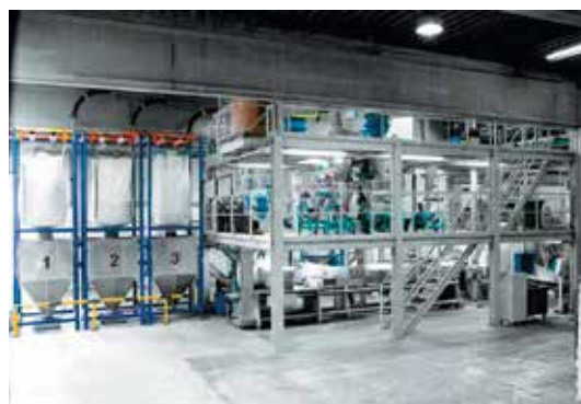
Heinke: apelo do corte de custos operacionais favorece silos estacionários e transporte pneumático de descarga de big bags.
