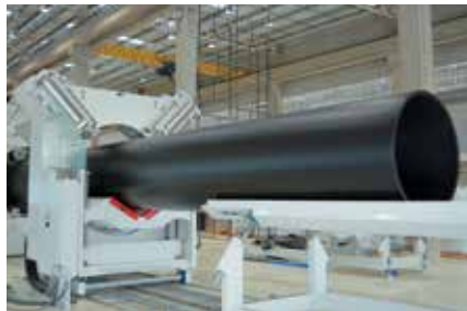
Tubo de PEAD: grade da Braskem dobra vida útil.
