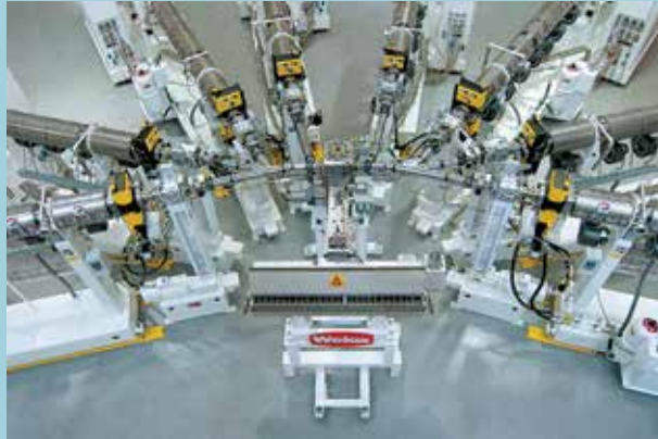
Welex: linha com nove extrusoras para chapas de cinco camadas.
