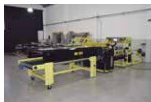
VM 1100: linha de corte e solda com mesa empilhadeira.
