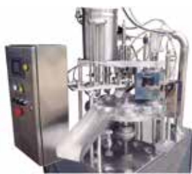
CG 1800: sistema eletropneumático com CLP.
