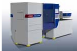
Ecopower: motores funcionam como geradores.
