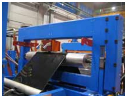
Electronic Systems: medição de espessura, gramatura e umidade do filme.
