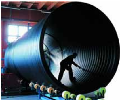
Weholite: tecnologia para diâmetros de até 3500 mm.
