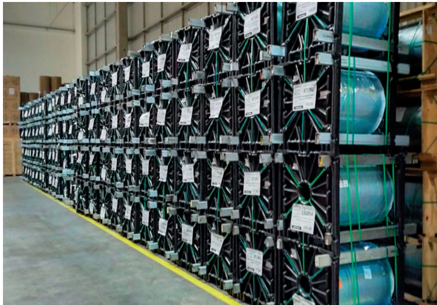
Port Roll: células de segurança para as bobinas formadas por duas placas de PP e quatro barotes metálicos.
